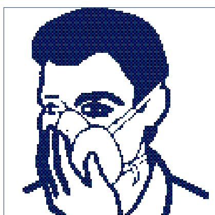
5. Faça uma prova de ajuste de pressão positiva. Coloque a palma da mão sobre a válvula de exalação e exale com suavidade; O respirador está bem ajustado se inchar ligeiramente e se não forem detectadas fugas de ar entre os bordos do respirador e a cara. Se for detectada uma fuga de ar, volte a colocar o respirador e reajuste a tensão das bandas de fixação e do arnés. Repita a prova de ajuste. Se não consegue um ajuste adequado, não entre na área contaminada. Consulte o seu supervisor.
