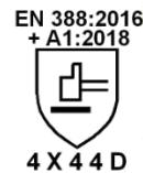
Luva de proteção contra riscos mecânicos, adequada para proteção contra cortes.
