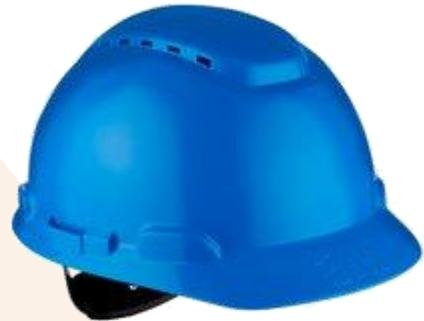
Para uma proteção da cabeça confortável, resistente e leve que pode suportar temperaturas frias, utilize Capacetes 3M™ Série H700. A faixa de cabeça ventilada oferece maior conforto e o arnês de cabeça pode ser girado 180° para melhor visibilidade ao trabalhar em espaços confinados. Eles estão disponíveis com suspensão pinlock ou catraca e aprovados para uso a -30 °C (EN397:2012) e -50 °C (GOST EN397:2012).
